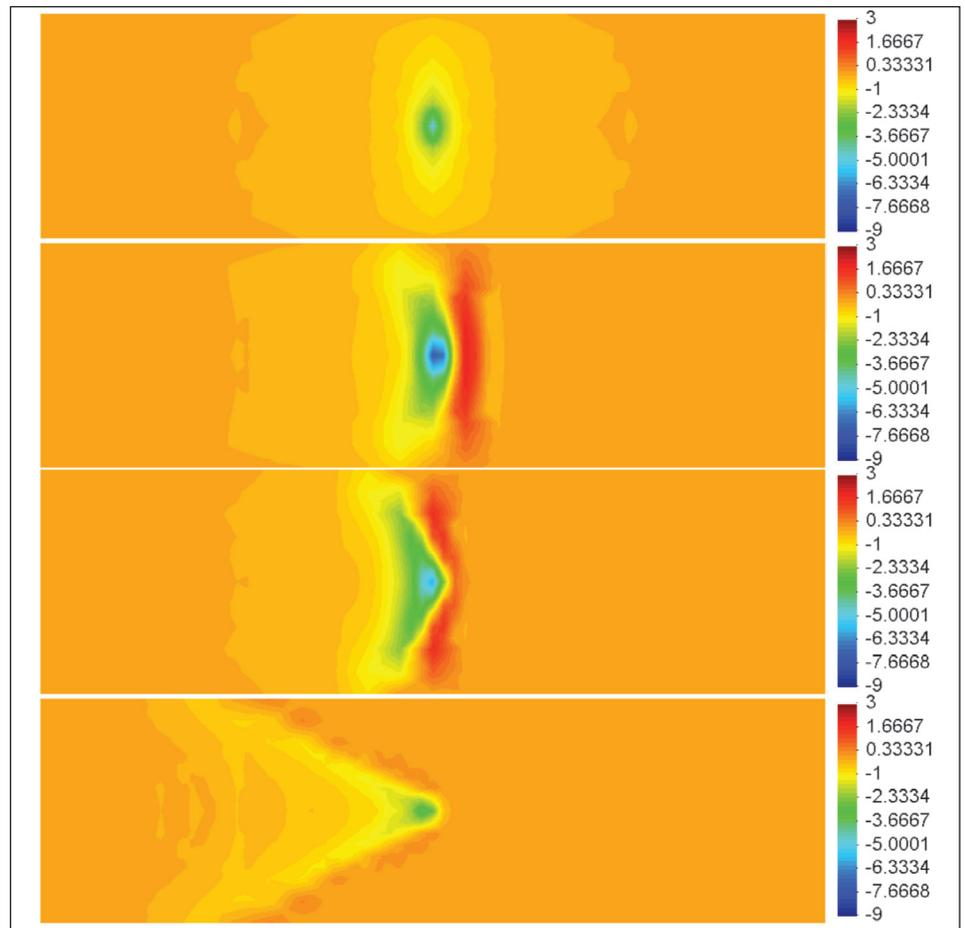
Figure 1. Vertical soil surface dimensionless displacements  $G(t)$ : (a)  $0 < v < C_R$ ; (b)  $C_R < v < C_S$ ; (c)  $C_S < v < C_P$  and (d)  $C_P < v < \infty$
